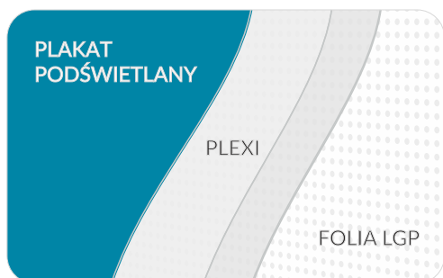
Przekrój warstw wkładu podświetlającego
